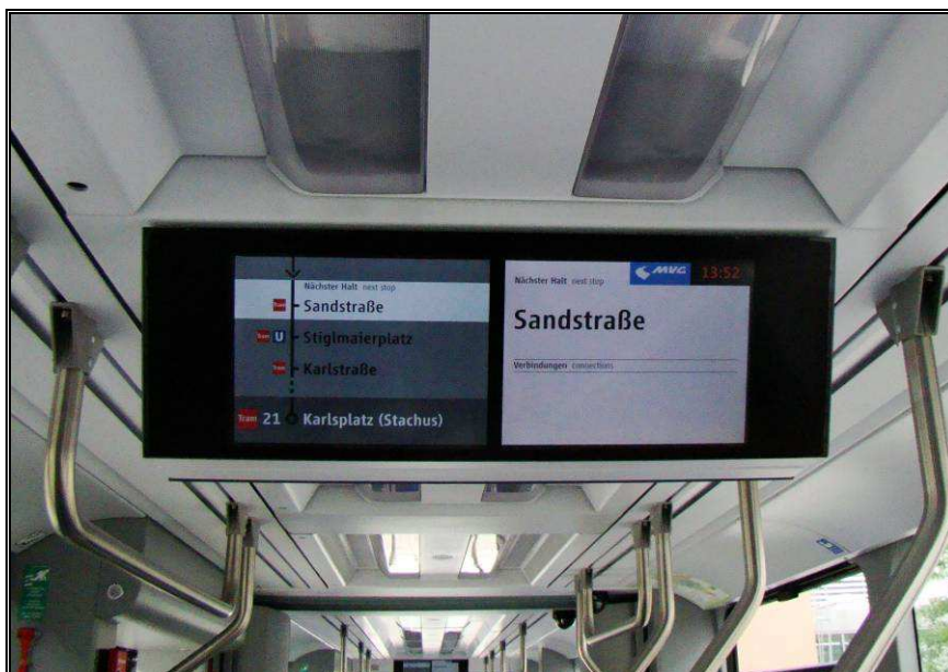
29. ábra: Fedélzeti információs rendszer utastéri LCD kijelzővel, Münchenben. (Fotó: Ekés András)
