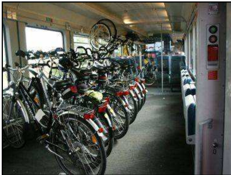
17. ábra: Kerékpárszállításra kialakított InterCity vezérlőkocsi a Német Vasút vonalán. (Forrás: http://www.adfc-lev.de/Fotos/Fotogalerie/2007/Tourenberichte/PG-Main_10-70000-Zugabteil.jpg )
