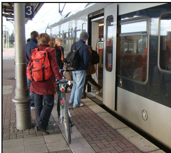
14. ábra: Kerékpárszállítás FLIRT járművön Németországban, magasperonos, szintbeni beszállás mellett. (Fotó: Ekés András)
