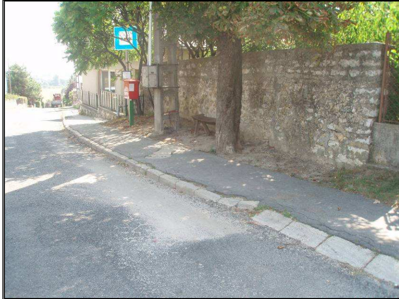
14. ábra: Szentjakabfa, Fő utca megálló. A járda burkolatának felújításával és a menetrendi tábla átalakításával akadálymentesíthető a megálló. (Fotó: Millei Balázs)
