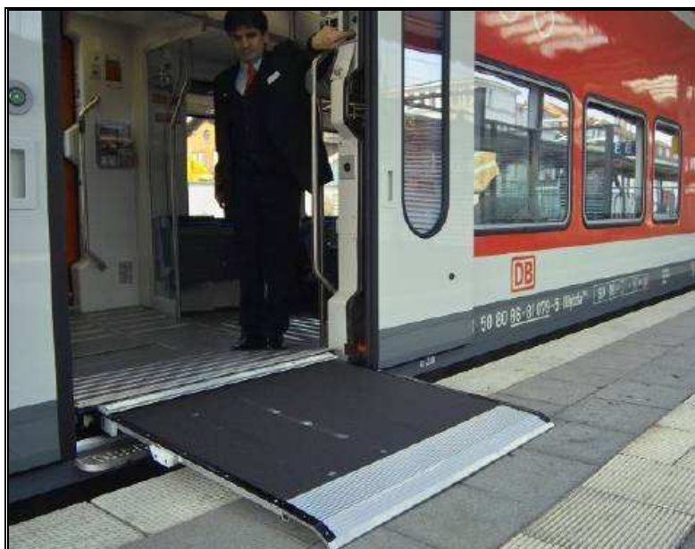
5. ábra: Akadálymentes emeletes vagon a Német Vasút (DB) vonalán. A peronon a biztonsági sáv szegélyezése a vakok és gyengénlátók számára érzékelhető. (Forrás: http://www.vbbonline.de/download/pdf/fahrinfo_hilfe_barrierefrei.pdf )
