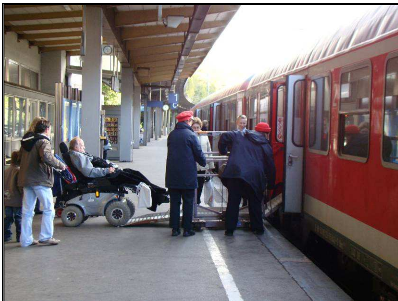
4. ábra: Kézi emelő magaspadlós vonatokra történő kerekesszék beemeléséhez. (Wuppertal, fotó: Ekés András)
