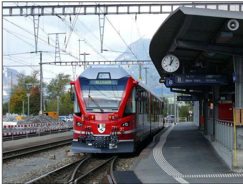
7. ábra: Akadálymentes (vakvezető sávval is ellátott), a jármű padlószintjének magasságához igazított peron Svájcban, Landquart állomáson (Forrás: Hiba! A hiperhivatkozás érvénytelen.)
