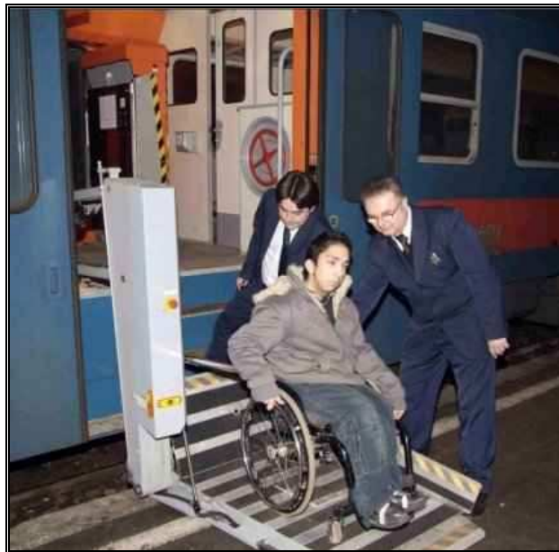
3. ábra: Kézi vasúti emelőberendezés a MÁV-Start vonatánál. (Forrás: http://www.logsped.hu/vl.jpg )
