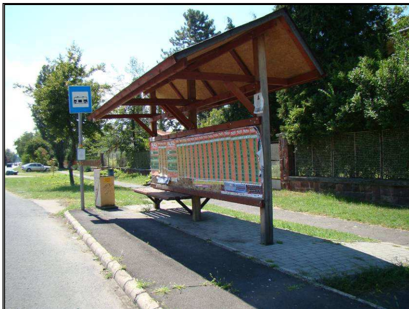
13. ábra: Szántód, Gyermeküdülő megálló. Az akadálymentesítési feladat az információk elérhetőségének biztosítása a menetrendi tábla átalakításával és a taktilis sávok beépítése a járdaburkolatba. (Fotó: Ekés András)
