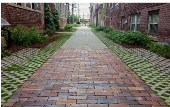
Különböző burkolatok vízáteresztő képességének jó kihasználása
