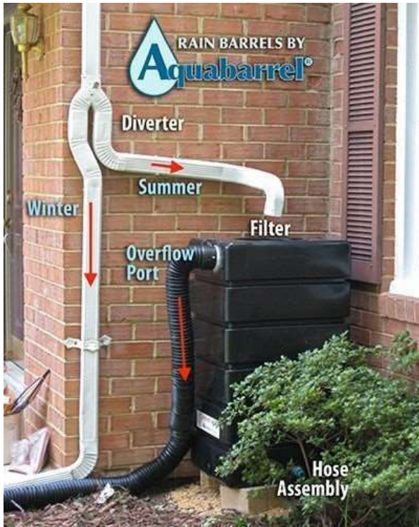
Esővíztartály téli-nyári üzemmódjának szemléltetése
