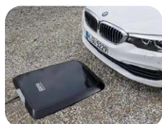
Indukciós töltő (fejlesztés alatt, nincs kapcsolat a töltő és a jármű között) Pl.: Kína szabványosította az indukciós töltést. A töltő tölthet álló helyzetben parkolás-kor, de haladás közben is indukciós útfelületen haladva.
